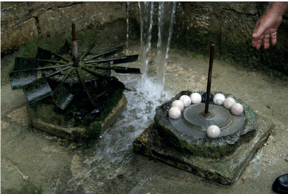
Abb. 27. Geöffnete Kugelmühle in Grödig am Untersberg mit einem „Schleifer“ (Bodenstein) aus Högler Sandstein. Die Kalkkugeln werden von einem aus Eichenholz bestehenden „Läufer“ bewegt. – Foto G. Lehrberger.
